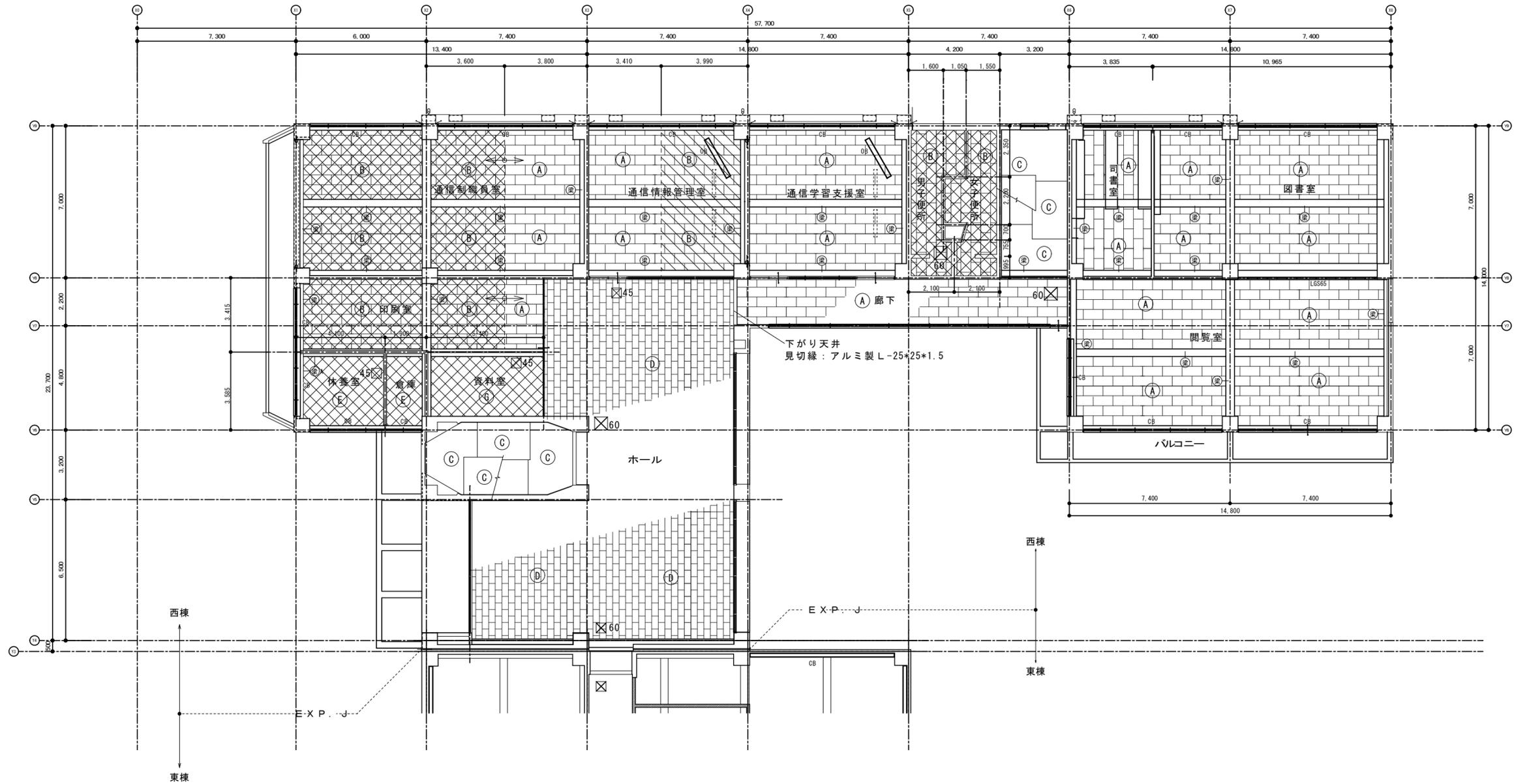
西棟 2階天井伏図 [改修後] 1/150
